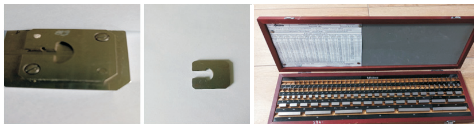
Rys. 1. Sprawdziany szczękowe i komplet płytek wzorcowych
